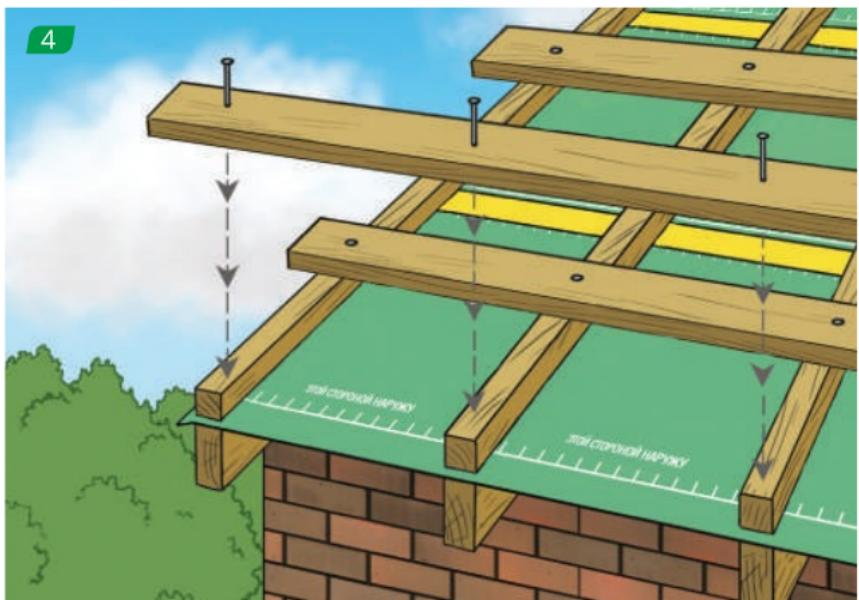
Поверх прижимного бруска устанавливаем горизонтальную обрешетку.
