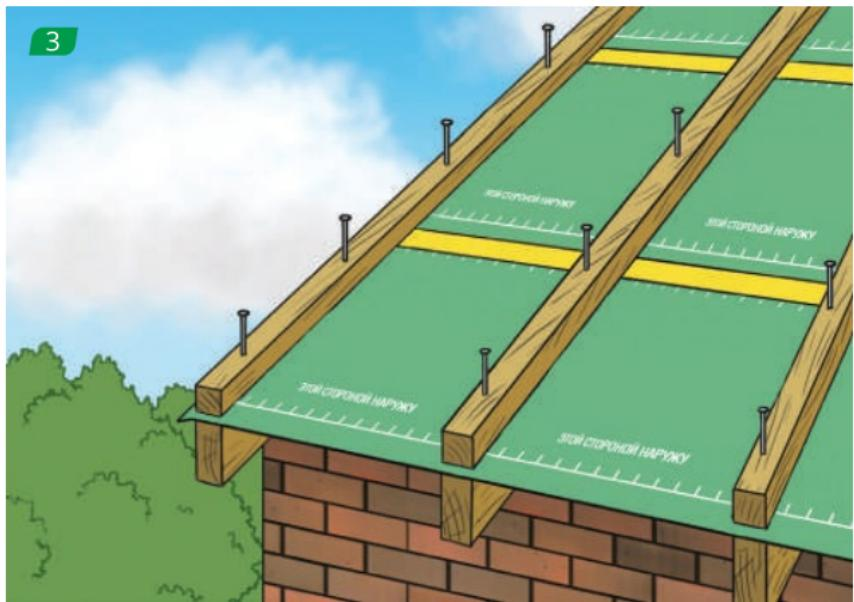
Устанавливаем поверх мембраны прижимной брускок и фиксируем его к стропилам.
